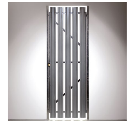
TÜREN IM MAUERWERK 180° öffnend, aushängesichere Bänder (zweiteilig), standardmäßig vorbereitet für Vorhängeschloss, in den Breiten 875/1000/1250 mm und Standardsystemhöhen.
