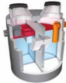
Für die mechanische Reinigung von Ölerschmutztem Regenwasser aus Verkehrsflächen. Mineralölabscheider nach dem Schwerkraftverfahren mit Schrägklärtechnologie im Kreuzstromverfahren
