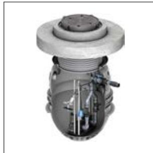
Geeignet für: Grau- und Schwarzwasser, Einsatz hinter Fettabscheider bis NG 10, Doppelpumpstation zum Sammeln und automatischen Heben von fäkalienhaltigem, und fäkalienfreiem Abwasser, über die Rückstau ebene. Zum Einbau ins Erdreich, Behälter aus Polyethylen LLD-PE, Nenndurchmesser 1320 mm, lichte Weite 1100 mm Traverse aus Edelstahl, Unterwasserkuppelungs-Automatik zur Aufnahme von ACO Tauchmotorpumpen mit Kuppelungsstück
